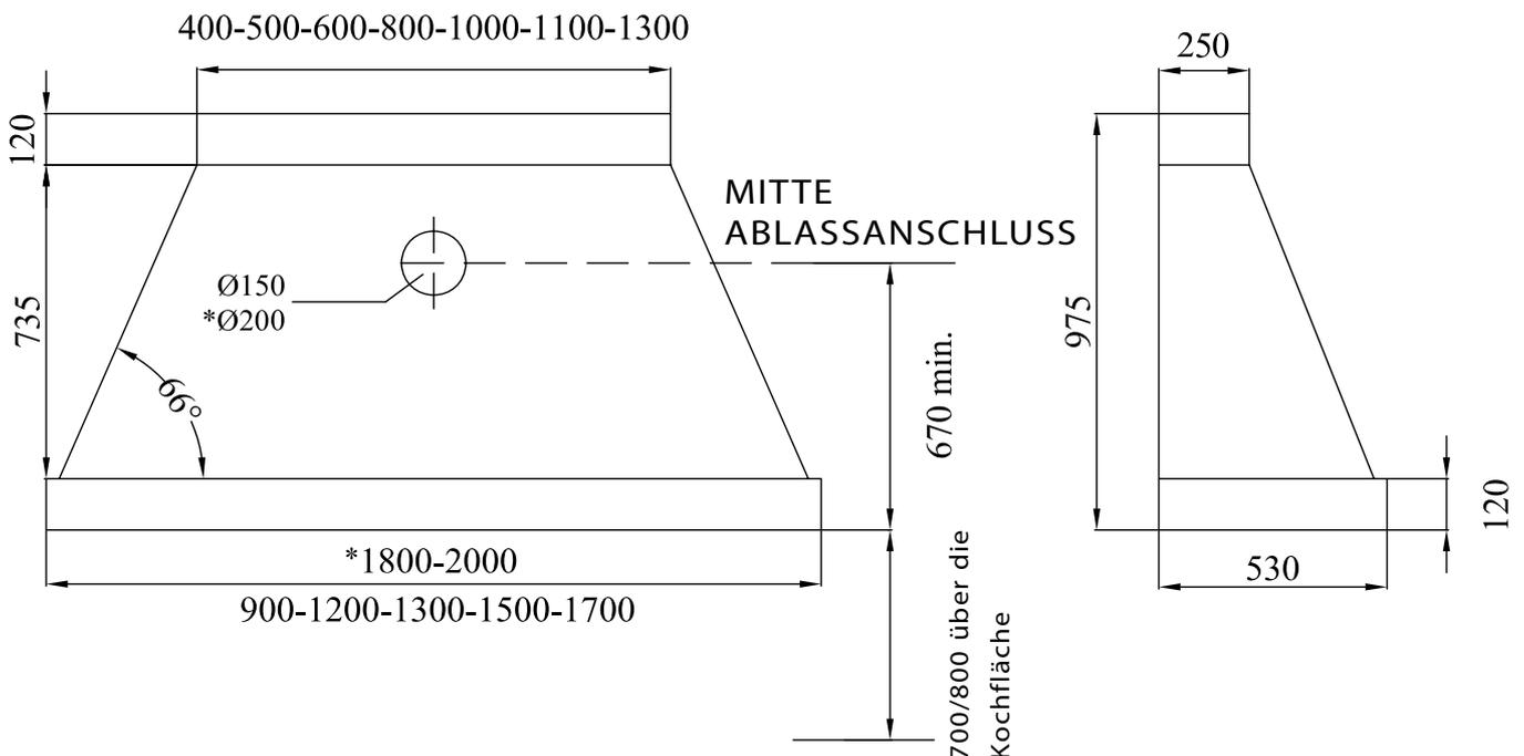
Die Abzugshaube nicht in einem kleineren Anschluss als vorgesehen anschließen. Es besteht die Gefahr von Fehlfunktionen und Überhitzung des Motors. Wenn die Realisierung den Abluftanschluss  $\varnothing$  200mm (1200mc/h) nicht möglich ist, wie Standard vorgesehen (K180-200), es wird empfohlen die Abzugshaube mit einem  $\varnothing$  150mm (900mc/h) Motor anzufordern.
